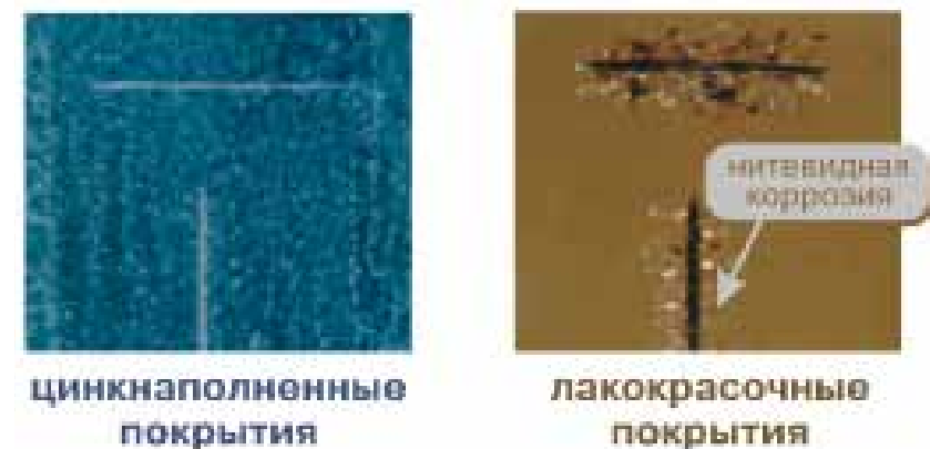
Рис. 1 Особенность защитного механизма цинкнаполненных покрытий
